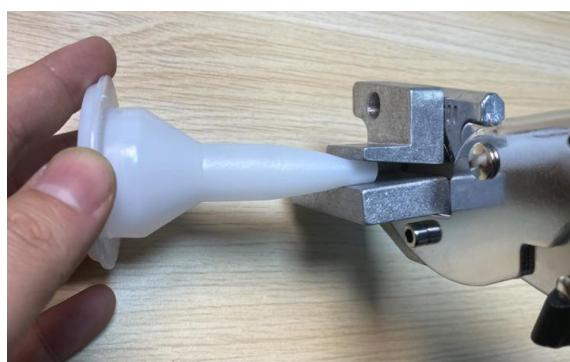
3、使用工具剪的压平模挤压胶嘴成型至所需尺寸；
