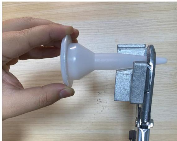
1、使用直尺或卷尺量取胶嘴头部 20mm 长度，确认切割位置，再使用工具剪切除；
