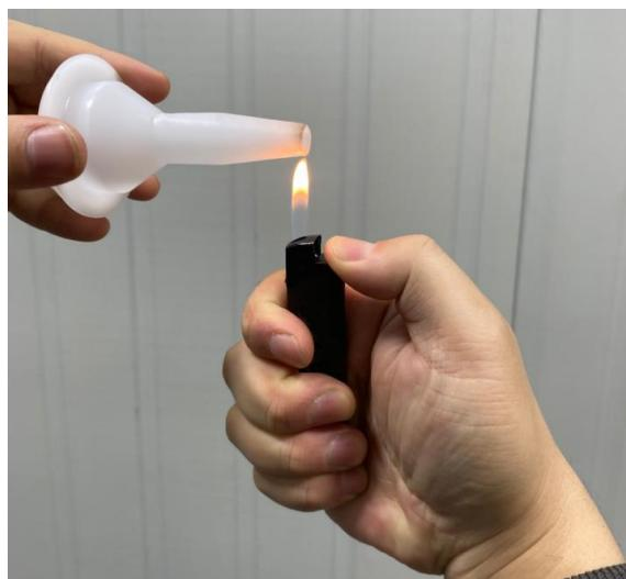
2、建议使用打火机加热胶嘴头约 2s，防止其被压扁后回弹；
